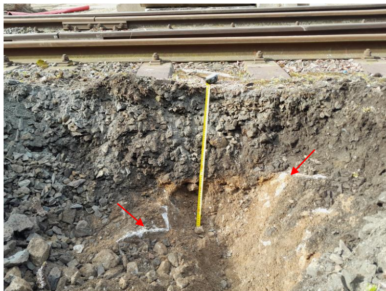
Kopaná sonda KS-3 (mezi kolejemi) (balvany anebo rozpukaný granit - červené šipky)
