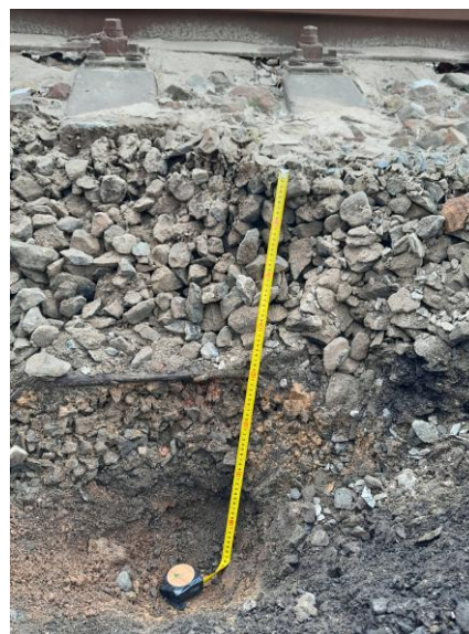
Kopaná sonda KS-10 (mezi kolejemi 1 a 2)
